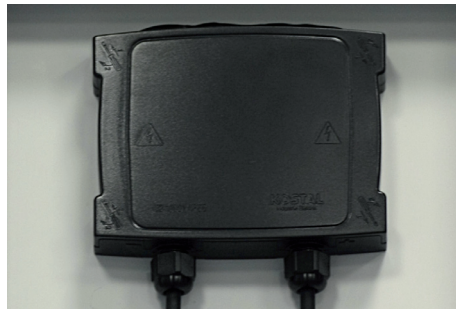
Abb. 17: Auf der Rückseite sind die Zellen in den meisten Fällen durch eine weitere fest eingebundene Folie vor Umwelteinflüssen, wie Feuchtigkeit, geschützt. Andere Module haben auch auf der Rückseite eine Glasabdeckung. Ebenfalls rückseitig angebracht sind Anschlussdose, Leitungen und Stecker.
